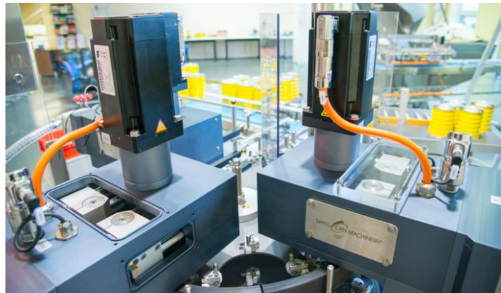
Hijyenin önemli olmadığı alanlarda İsviçreli firma AKM yapı serisinden standart servo motorları kullanıyor.
